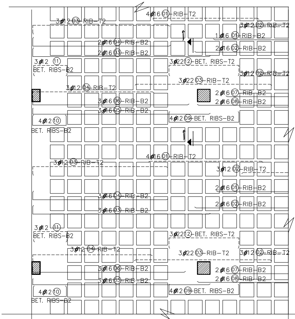
شكل رقم (٧-١) تفاصيل تسليح البلاطات المسطحة ذات الأعصاب
